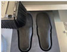
データ化された足型を反転処理し、自動切削機で削り出します。
